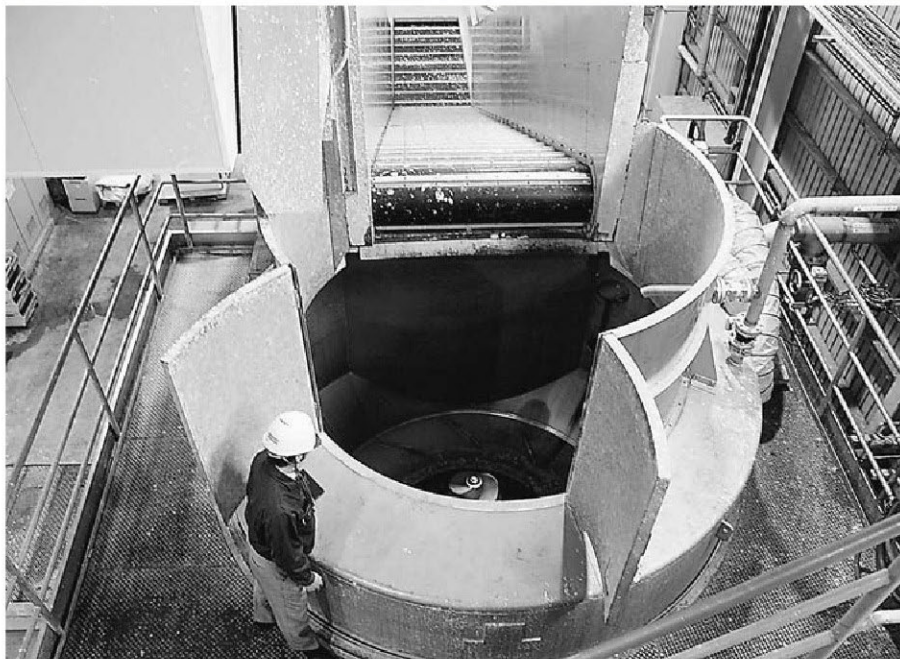
溶解処理に使われる「パルパー」。上部のコンベヤーから段ボールに入ったままの機密書類が投下され、かき混ぜて水に溶かす
